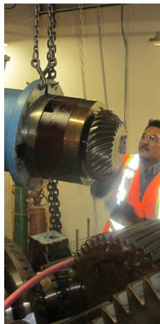
**Sumitomo Drive Technologies** como parte de sus valores agregados ofrecidos a la **Industria de Aceite de Palma**, cuenta con la provisión de servicios de reparación en planta, en este caso se muestra un reductor **Paramax® 9080** que sirve a la industria pesada de Latinoamérica.
