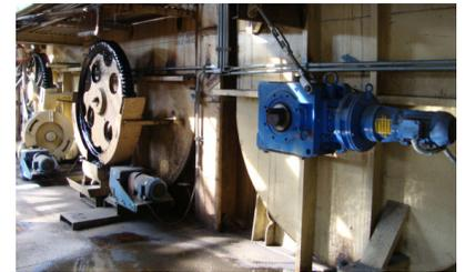
Nuestros motorreductores BBB4 han sido una alternativa eficiente para reemplazar transmisiones complejas y de recurrente mantenimiento. Con lo cual, utilizando este tipo de caja con brazo tensor se han desarrollado varios proyectos para clarificadores de meladura en ingenios mesoamericanos y sudamericanos, generando menos puntos de falla, una mejor apariencia, menos ruido, refaccionamiento inmediato y sobretodo, un muy bajo mantenimiento.
