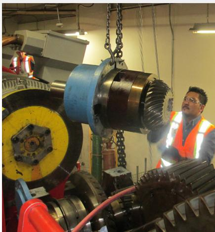
Sumitomo Drive Technologies como parte de sus valores agregados ofrecidos a la industria minera, cuenta con la provisión de servicios de reparación en planta, en este caso se muestra un reductor Paramax® 9080 que sirve al sector minero de la extracción de carbón.
